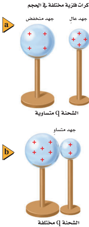
■ الشكل 3-12 تنتقل الشحنات من الكرة ذات الجهد الأعلى إلى الكرة ذات الجهد الأقل عند تلامسهما، ويستمر انتقال الشحنات إلى أن ينعدم فرق الجهد بينهما.
