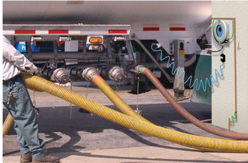
■ الشكل 3-13 سلك التأريض المتصل بصهريج نفط يمنع اشتعال بخار البنزين.
