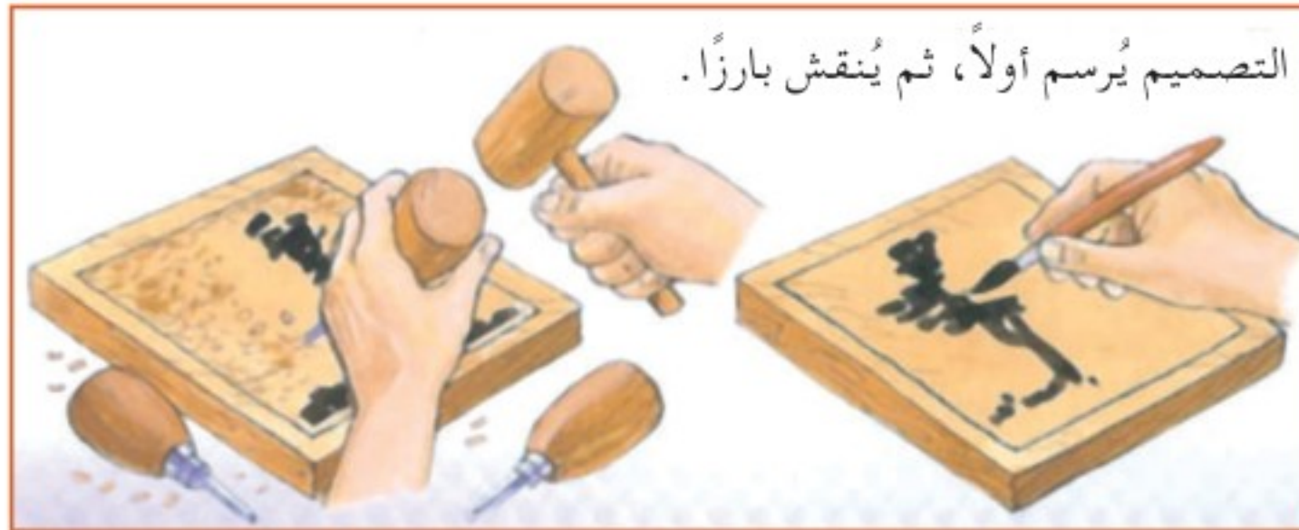
الشكل (٩٣) : طريقة تنفيذ الإشارات بالحفر على الخشب.
