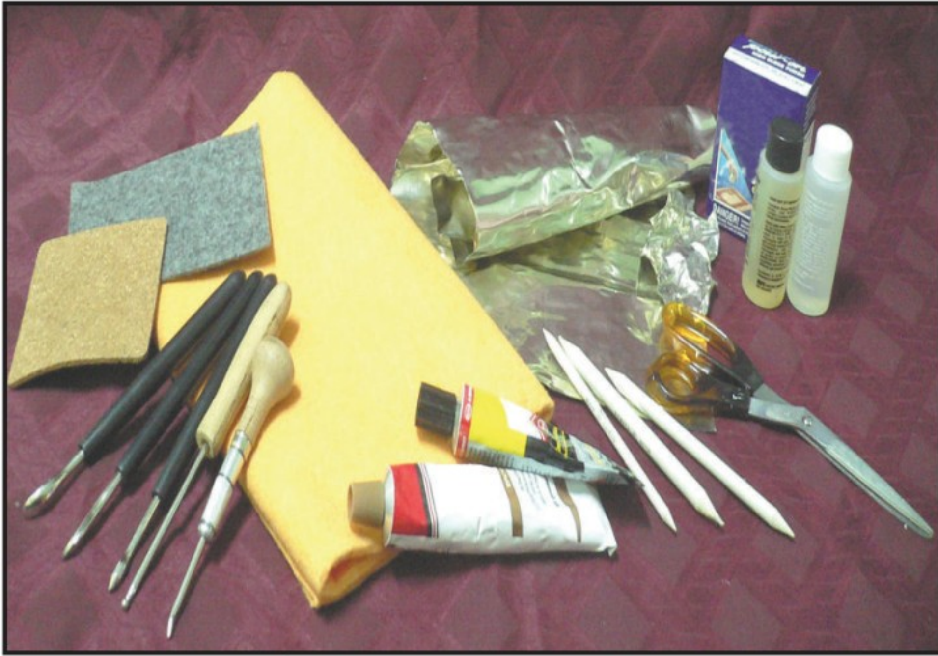
الشكل (٥٨): خامات وأدوات التلبيس الجزئي بالآيتان .
