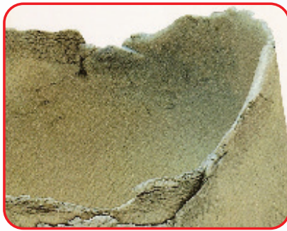
شكل ( ٥٢ ) : يوضح نتائج أخطاء التجفيف ( تشقق ).
