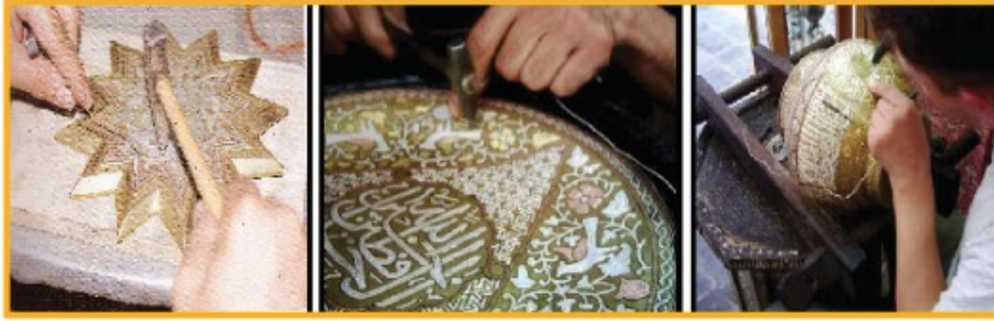
الشكل (٣٥): طريقة التكفيت
