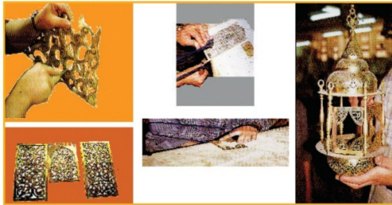
الشكل (٨)، طرق استخدام أزاميل ومنشار المعادن
