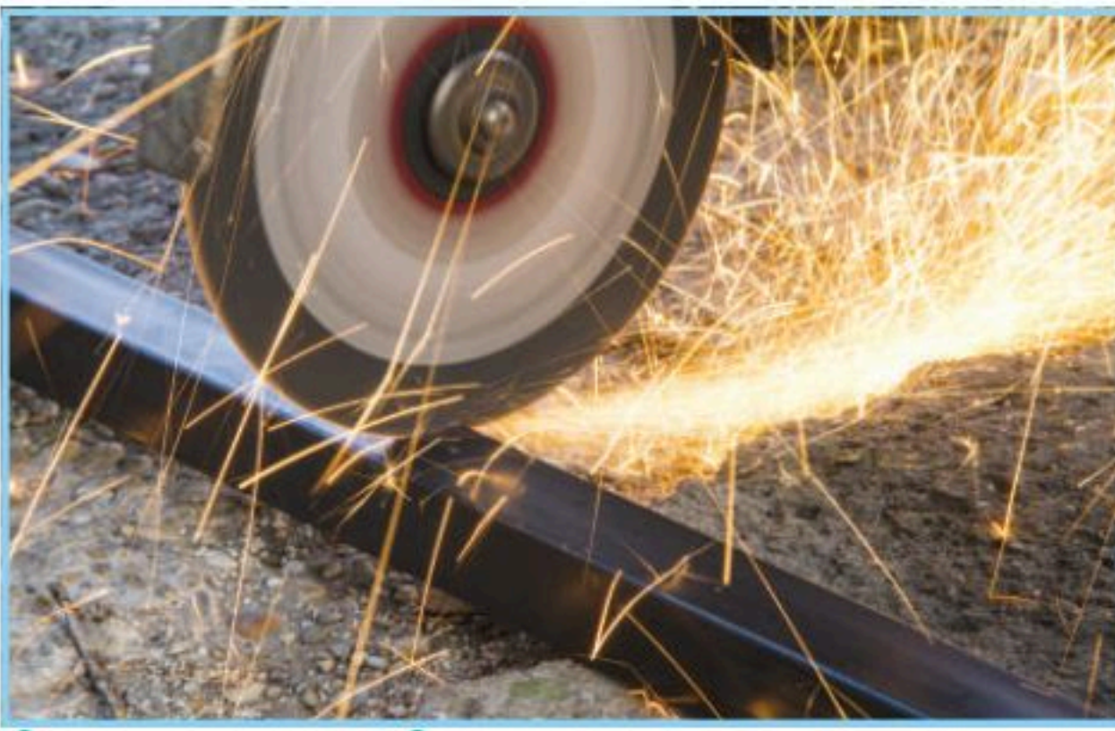
تتحوّل الطاقة الحركية إلى طاقة حرارية بسبب الاحتكاك.
