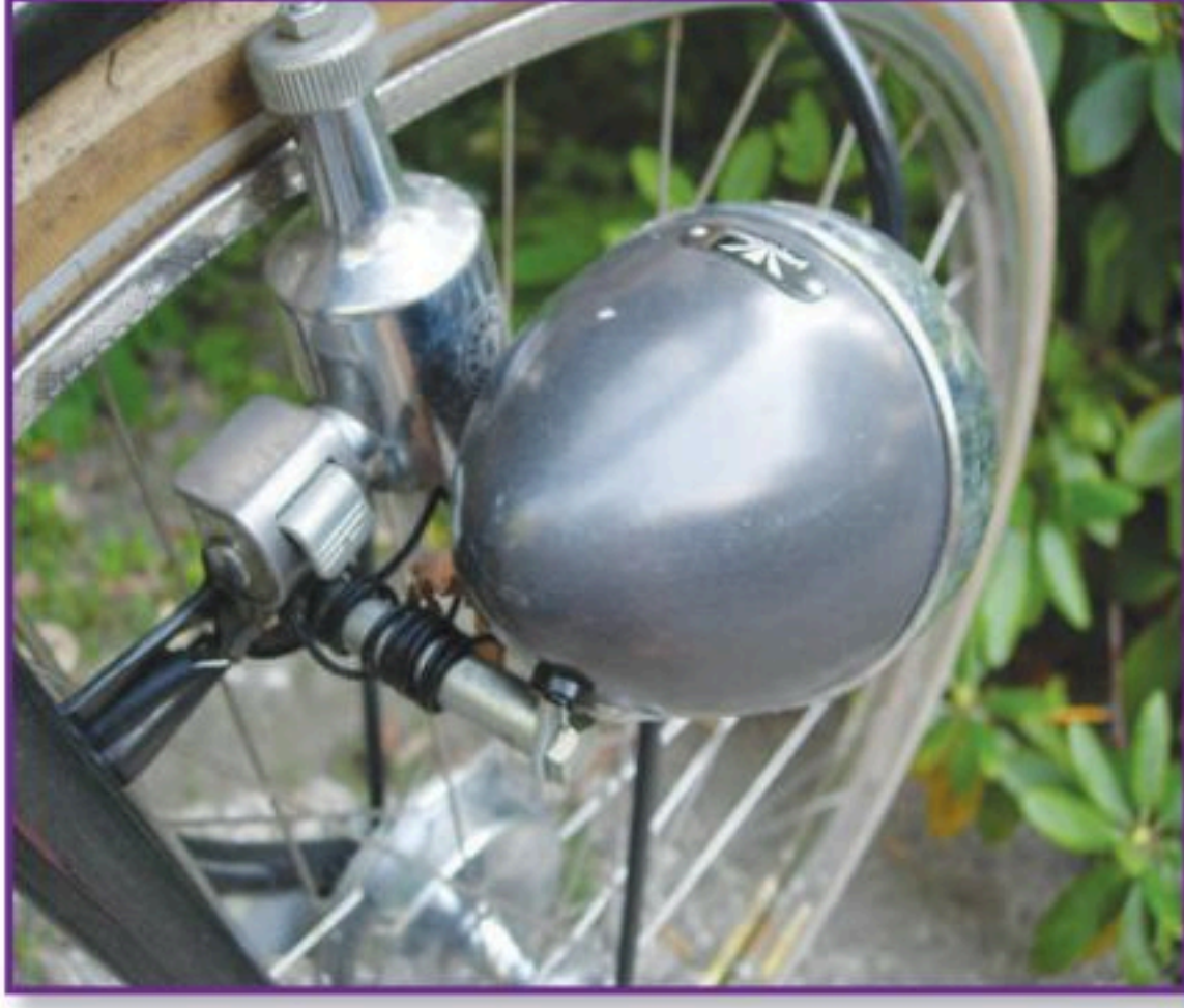
يتصل المولد الكهربائي بعجلة الدراجة
