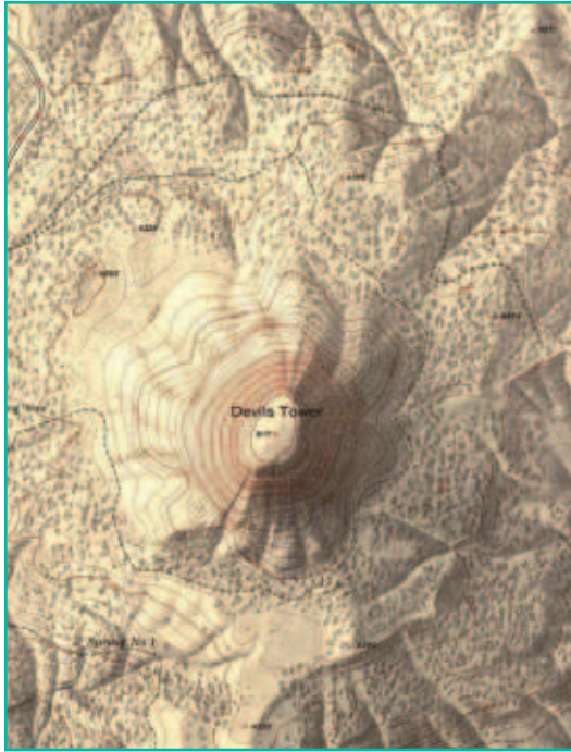
تمثيل الجبل السابق بخطوط الكنتور
